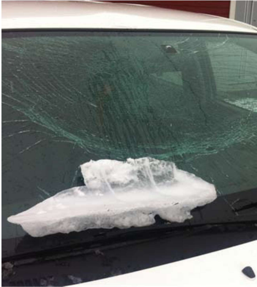
Figur 5: Isklump fra en vindturbin som har truffet en bil. Foto: Statkraft.
